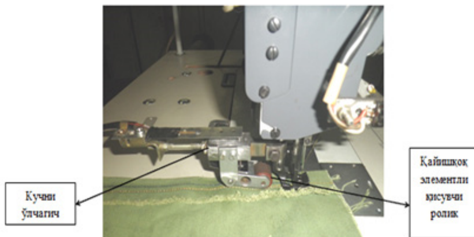
3-rasm. Tikilayotgan brezent materialni zichlovchi rolikning umumiy ko'rinishi.
