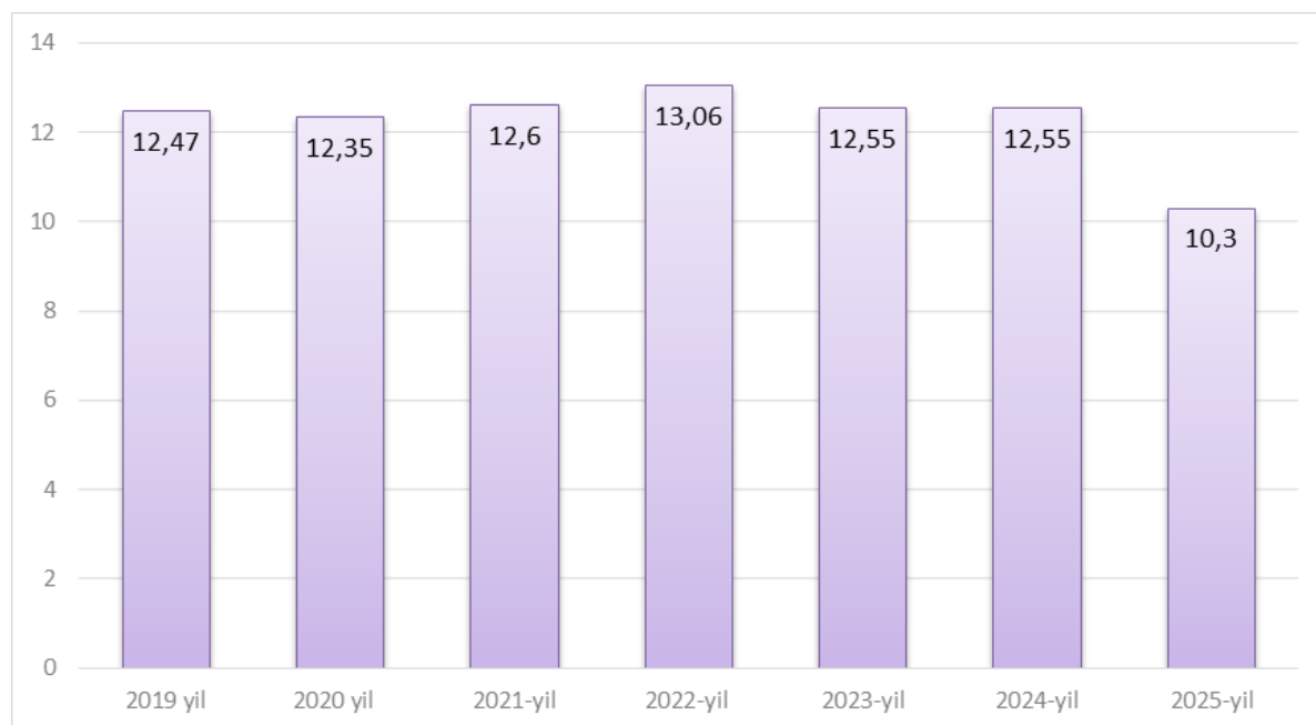
2-rasm. Elektr energiyasini uzatish va taqsimlash yo'qotishlari (ishlab chiqarishga nisbatan, %) [5]
