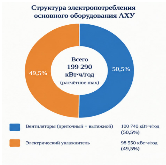
Рисунок 2 – Структура электропотребления основного оборудования AXU 2
