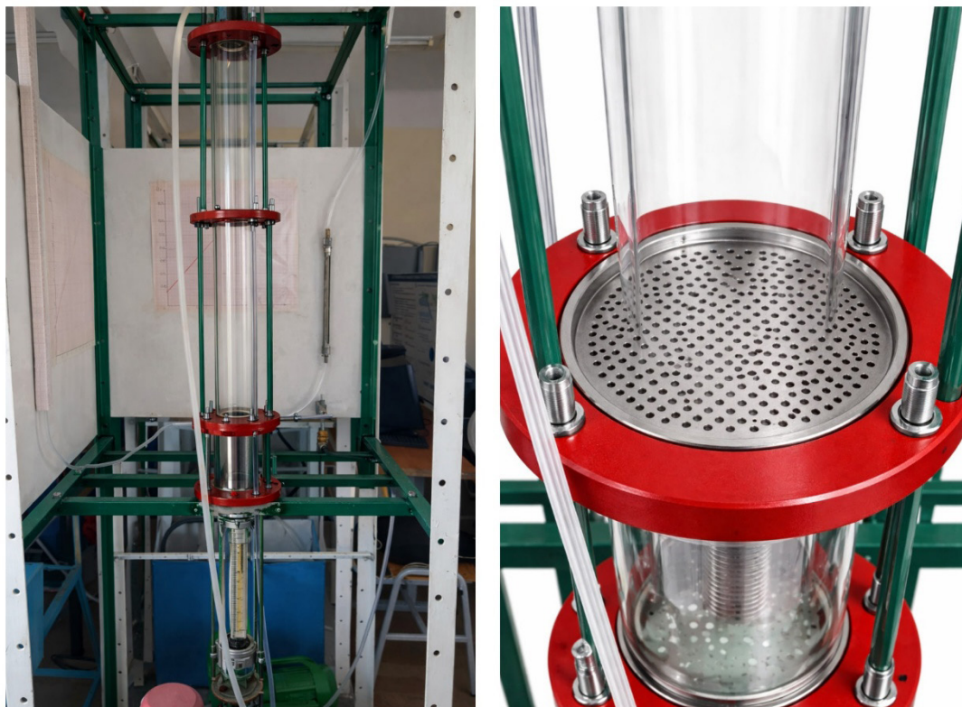
1-rasm. Tajriba qurilmasi va perforirlangan teshiklar ochilgan nasadkaning umumiy ko'rinishi 1
