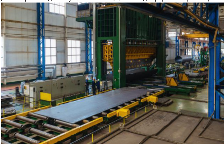
Рисунок 2. Линия формовки листа методом UOE 2
