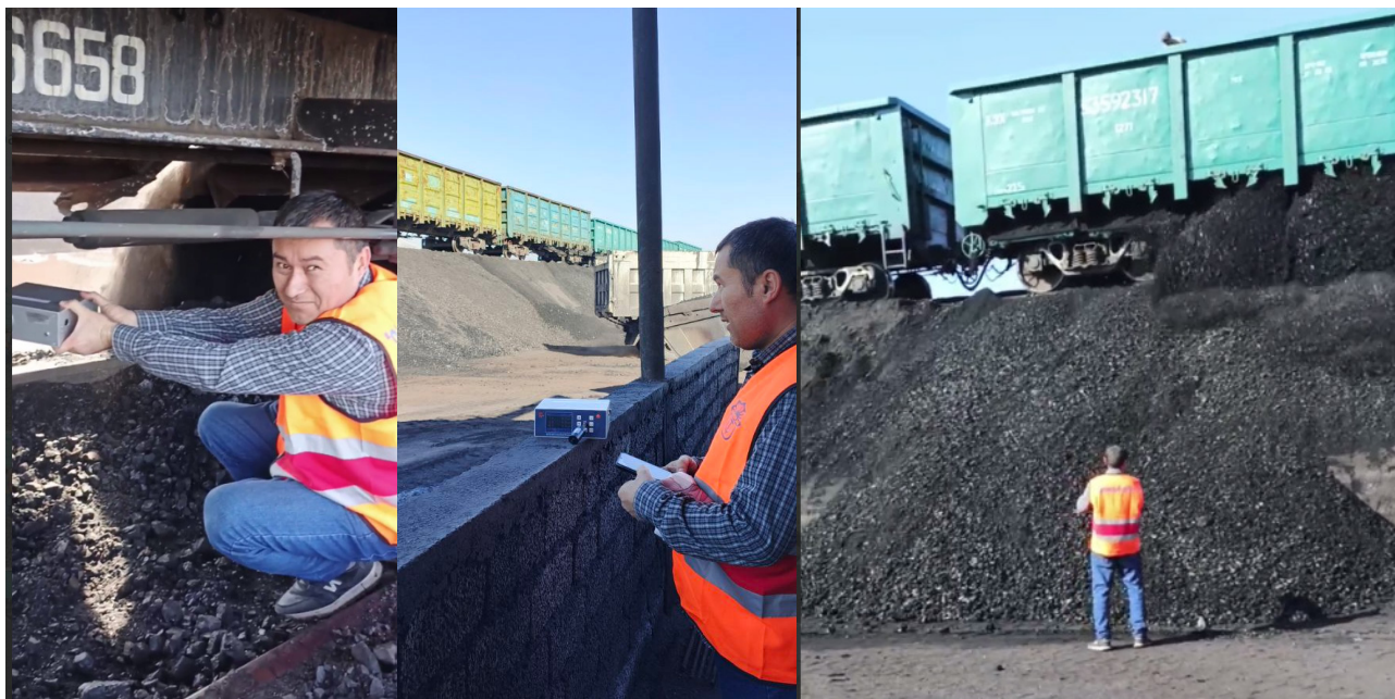
1-rasm. Ko'tarilgan temir yo'lda joylashgan yarim ochiq vagonlardan ko'mir tushirish jarayonida hosil bo'ladigan chang zarrachalarini o'lchash jarayonidan fotolavhalar 1
