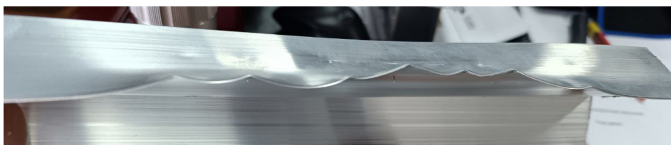
Рис. 2. Отбракованный профиль. Недопустимые отклонения в геометрии
