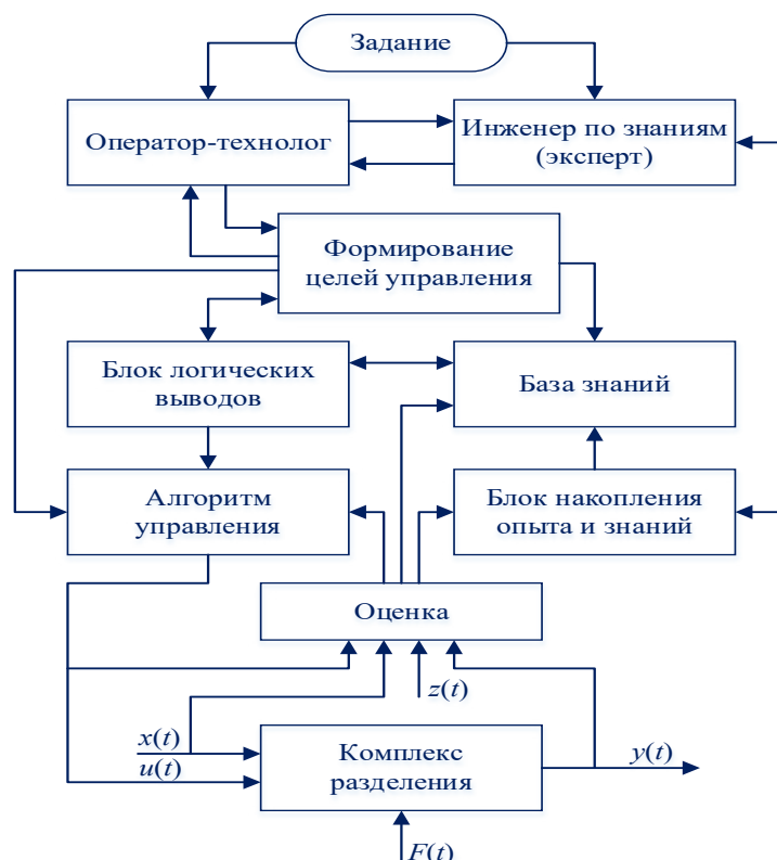
Рисунок 2. Структура предлагаемой интеллектуальной системы управления для разделительных комплексов, оснащённых множеством устройств.
