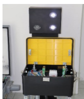
1-rasm. Rossiya davlatining "TMH intellektual tizimlari" kompaniyasi tomonidan ishlab chiqilgan strelkani simsiz boshqarish tizimi
