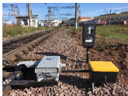
1-rasm. Rossiya davlatining "TMH intellektual tizimlari" kompaniyasi tomonidan ishlab chiqilgan strelkani simsiz boshqarish tizimi
