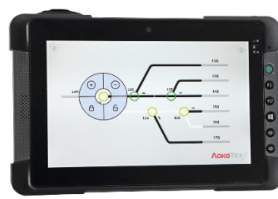
1-rasm. Rossiya davlatining "TMH intellektual tizimlari" kompaniyasi tomonidan ishlab chiqilgan strelkani simsiz boshqarish tizimi
